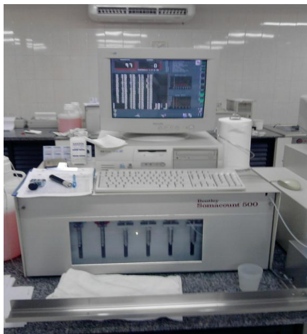
Figura 3. SOMACOUNT® 500 (Bentley Instruments, MN, USA) equipamento que realiza a
